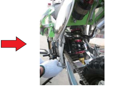
12、 Install rear shocker
