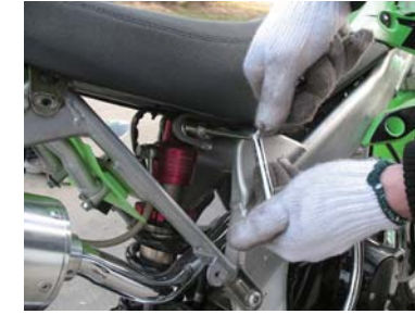
11、 Install rear shocker
